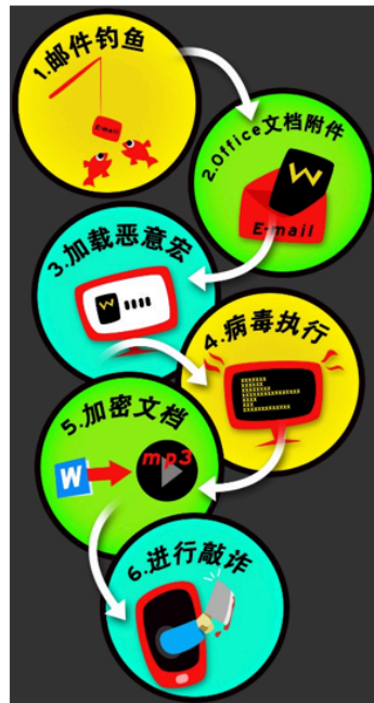
图：“密锁”五代伪装 Office 文档攻击流程
